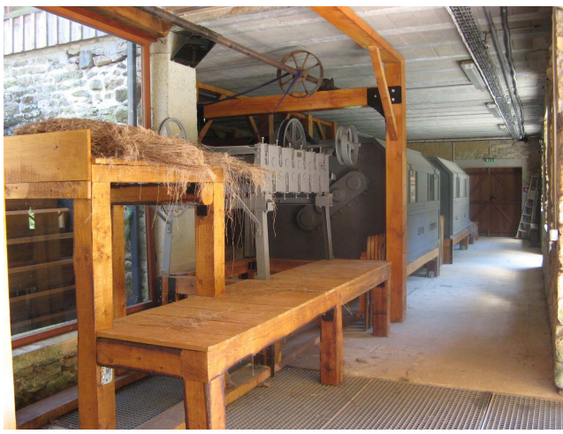
Réinstallation teilleuse après restauration
