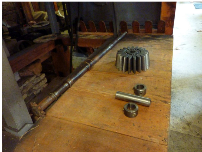
Vue latérale du pignon et des accessoires de fixation et d'accouplement
