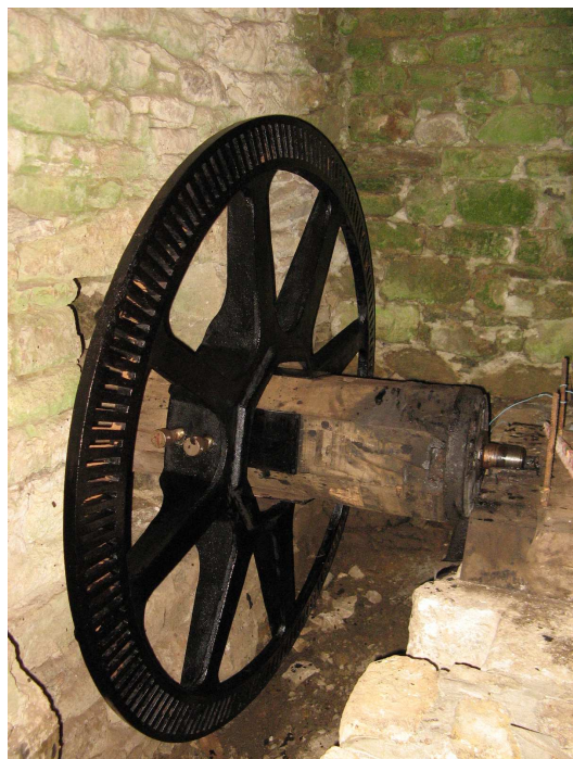
Mise en place de la grande couronne
