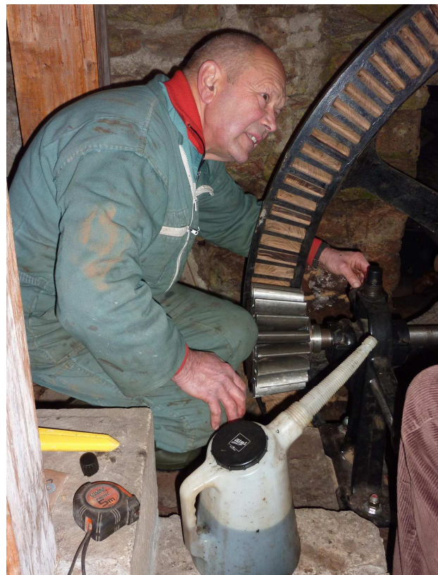
Le pignon est en place
