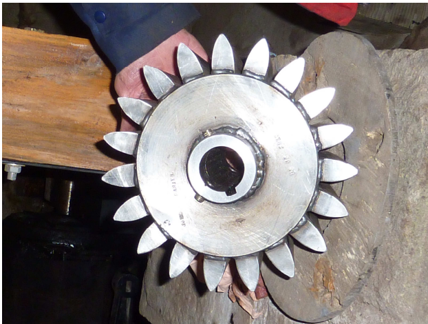
Le pignon est terminé et ses flasques soudées
