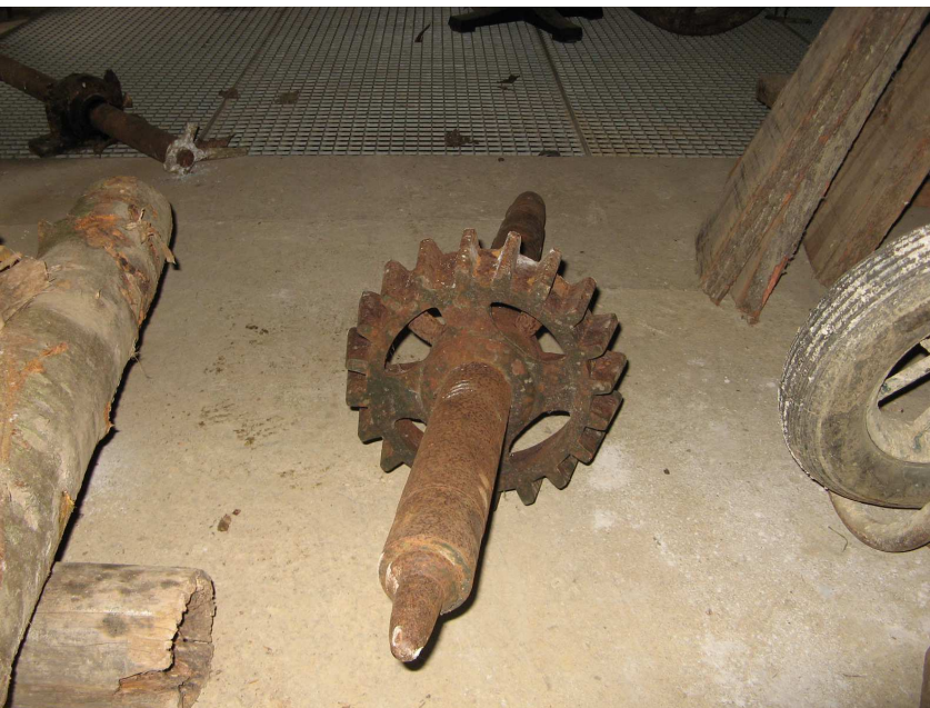
Petit pignon multiplicateur ; source du principal problème car les simulations ont détecté que le pas de ses dents n'était pas compatible avec celui de la grande couronne :il s'en fallait de 1 ou 2 mm
